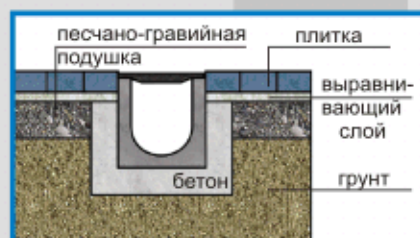
Пример установки водостока в тротуарах или бетонных мостовых
