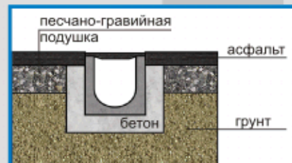
Пример установки водостока в тротуарах или бетонных мостовых
